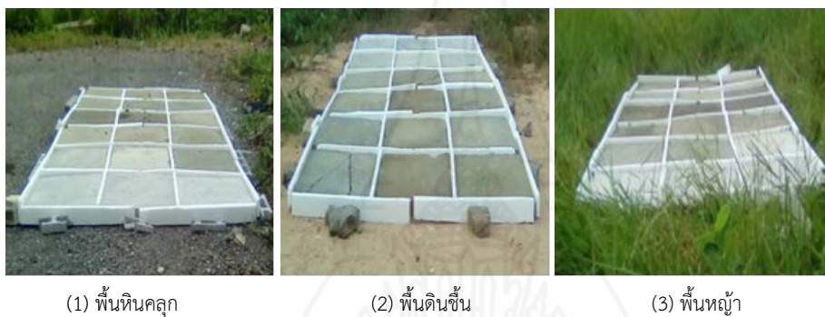
ภาพที่ 5 แสดงพื้นที่วางแผ่นพื้นคอนกรีตทางเท้าเพื่อวัดอุณหภูมิผิว
